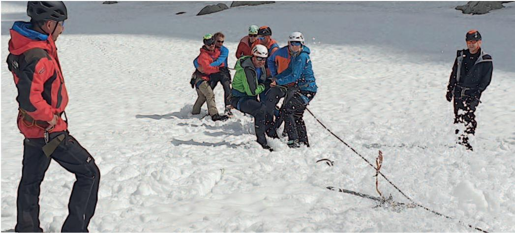
*Mit einem Dynamometer messen wir die Haltekraft eines T-Ankers im Schnee.*
